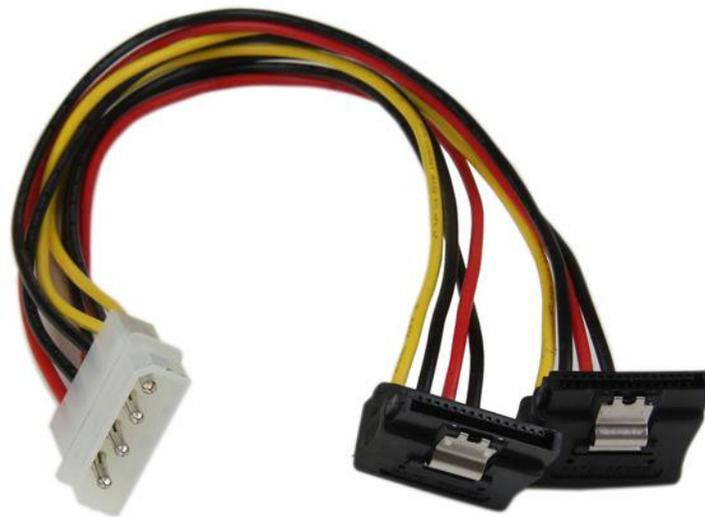
Este cable divisor de alimentación LP4 a Doble SATA de Ángulo Recto con Cierre de Seguridad, PYO2LP4LSATR dispone de dos conectores de alimentación Serial ATA hembra y de un conector LP4 macho - una solución confiable que permite alimentar dos unidades SATA mediante una única conexión LP4 a la fuente de alimentación del computador.
