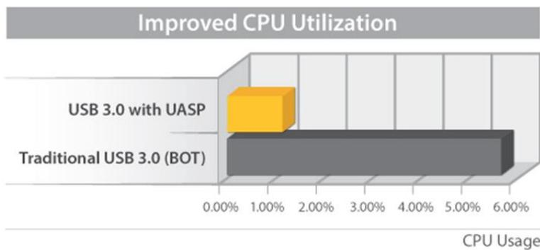
Los resultados fueron obtenidos utilizando un sistema Intel® Ivy Bridge, una caja de discos duros StarTech.com con UASP activado, y una unidad de disco SATA III de estado sólido.
