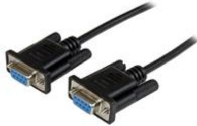
El cable de módem nulo DB9 de 2 metros, modelo SCNM9FF2MBK, incluye dos conectores DB9 hembra, lo cual permite conectar un dispositivo serie a un puerto serie de 9 pines, o transferir archivos directamente de PC a PC, a través de una conexión serie.
