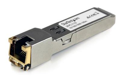
El modelo SFPC1110 es un módulo transceptor por cobre, compatible con el modelo SFP-GE-T de Cisco, diseñado, programado y probado para su funcionamiento con enrutadores y conmutadores de la marca Cisco®. Ofrece conectividad 1GbE (1000Mbps) confiable a través de cable de cobre para redes compatibles con 1000BASE-T, con una distancia máxima de hasta 100m.
